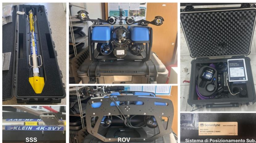
Figura 2. Diverse strumentazioni di Geologia Marina. A sinistra, il sistema Side-Scan-Sonar (SSS), al centro il Remotely Operated Vehicle (ROV), a destra il Sistema di Posizionamento Subacqueo.
